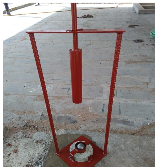
Fig. 1. Impact test apparatus
